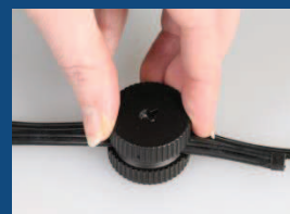
Bringen Sie die Schutzkappe auf den Stecker und drehen
