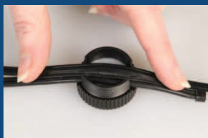
Druk beide kabels door de pinnen
